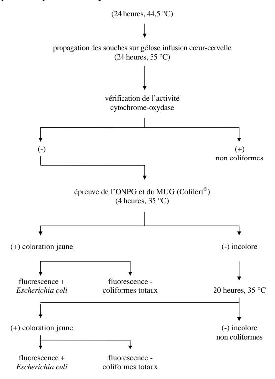
Figure 1 - Schéma du protocole de confirmation des colonies de coliformes thermotolérants (fécaux) à l'espèce *Escherichia coli*
