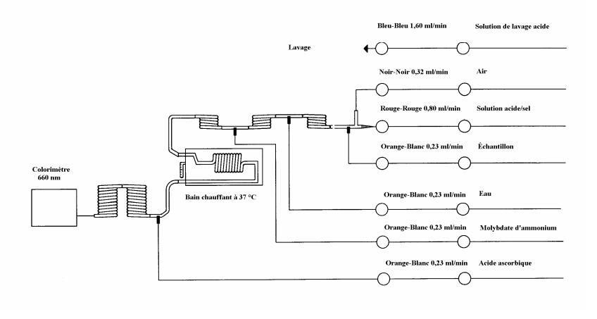
Figure 1 – Schéma de l'analyseur du phosphore total
