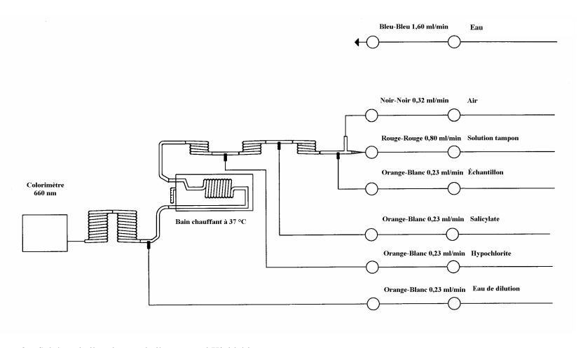
Figure 2 – Schéma de l'analyseur de l'azote total Kjeldahl
