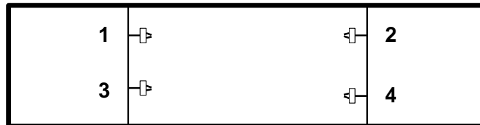
Figure 4. Exemples de l'emplacement des cassettes pour un événement de toit de type lanterneau
