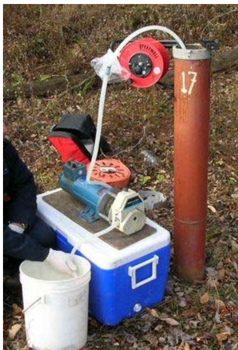
Photo 7. Purge à volume déterminé du puits d'observation. Le rabattement (présence de la sonde piézométrique) et le débit pompé (contenant blanc) sont contrôlés tout au long de l'opération (MDDEP, 2006)
