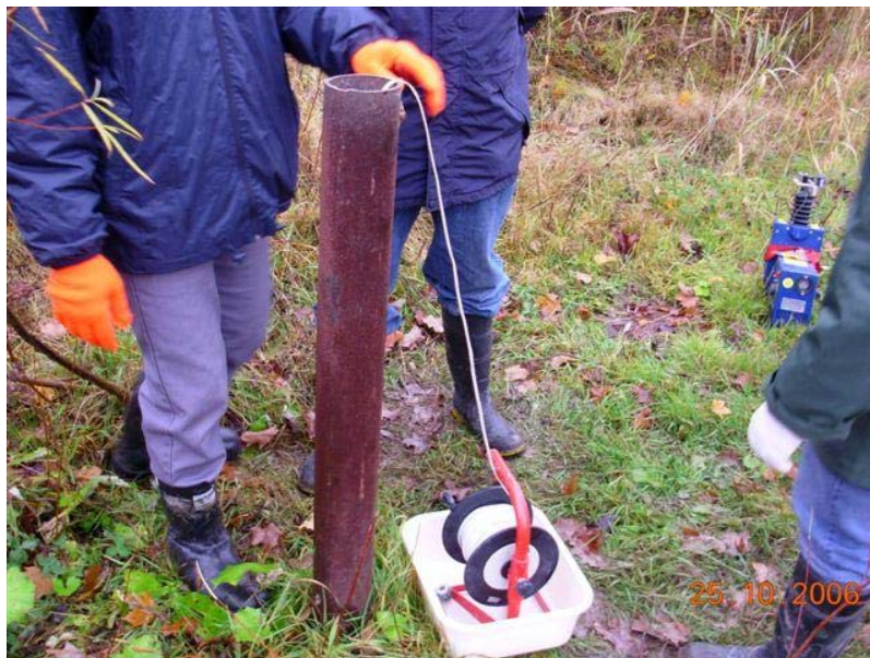
Photo 2. Mesure initiale du niveau d'eau dans le puits d'observation (MDDEP, 2006)
