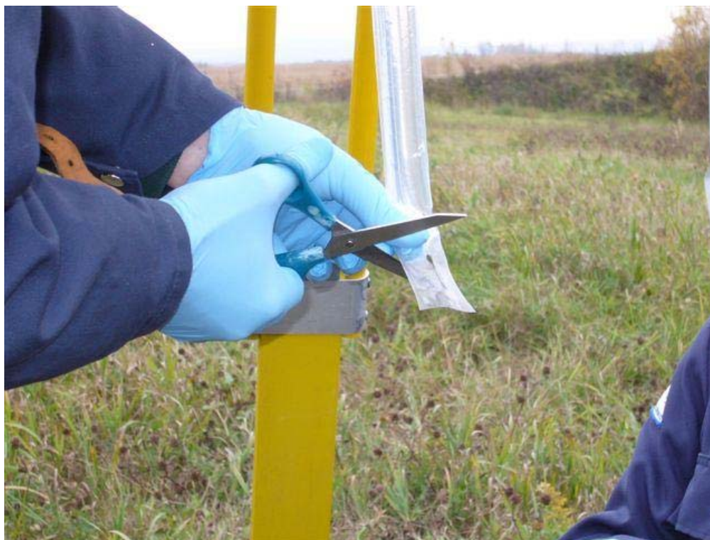
Photo 10. Opération de récupération de l'échantillon dans un sac à diffusion : les gants et les ciseaux doivent être exempts de contaminants (MDDEP, 2008)
