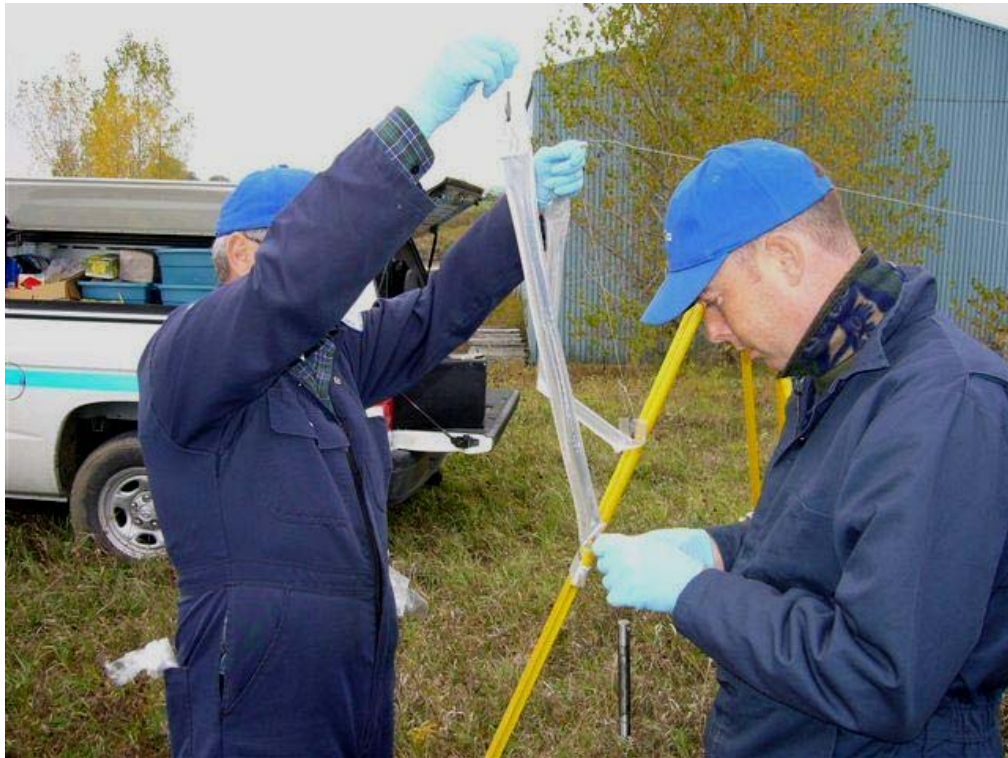
Photo 9. Exemple d'échantillonneurs passifs : sacs à diffusion (MDDEP, 2008)
