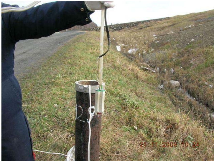
Photo 4. Exemple de pompe submersible (MDDEP, 2008)
