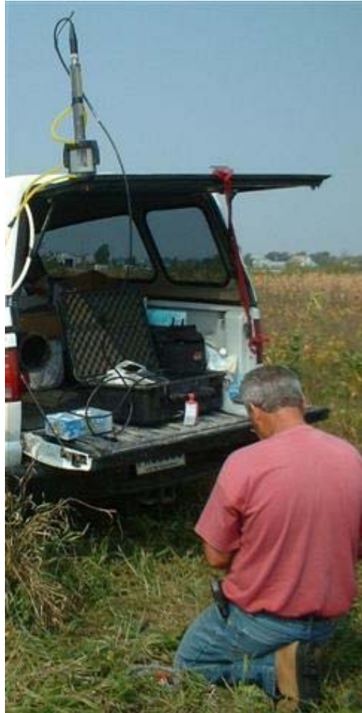
Photo 8. Mesure des paramètres physicochimiques. La cellule de mesure se trouve sur le toit de la voiture (MDDEP, 2010)
